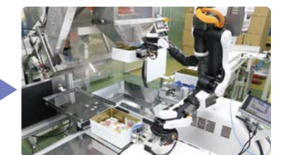
全体の重量から、米菓の内容量と員数をチェック。合格分のみ次の工程へ流す
