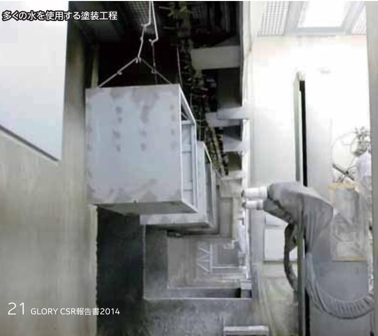
多くの水を使用する塗装工程
