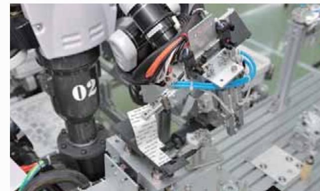
専用のアタッチメントを使用した両面テープの剥離紙はがし
