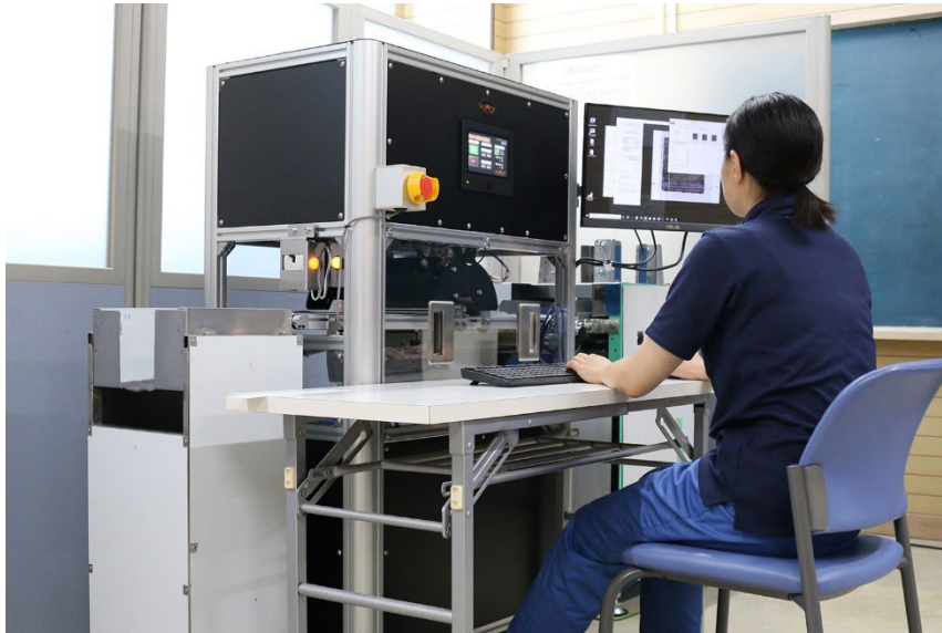
海苔色調検査機を使った実証実験の様子 (兵庫県漁業協同組合連合会 のり流通センター)
