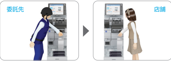
売上金回収時につり銭準備金を硬貨カセットに一時収納。
